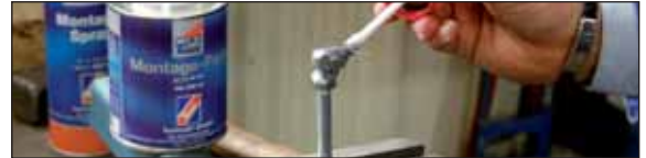
2. ... Technolit®-Montaj Pastası yoğun şekilde sürülür
